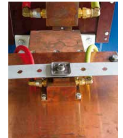
Blech und Buckelmutter in der Schweißmaschine
