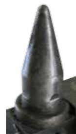
Zentrierstift aus gehärtetem Stahl
