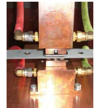
Schweißvorgang in der Buckelmutterschweißmaschine
