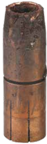
Gasdüse: VOLCERA nach 100 Schichten im Dauerbetrieb und Kupfer nach 1 Schicht.
