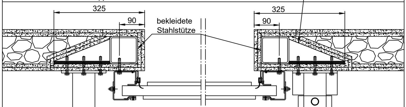
Die gesamte Unterkonstruktion (Rohre und Montagekonsolen) müssen vollständig mit einer EI30-Beklankung geschützt werden. Zwischen der geschützten Unterkonstruktion und nebenliegenden Wänden kann eine Trockenbauwand gesetzt werden.
