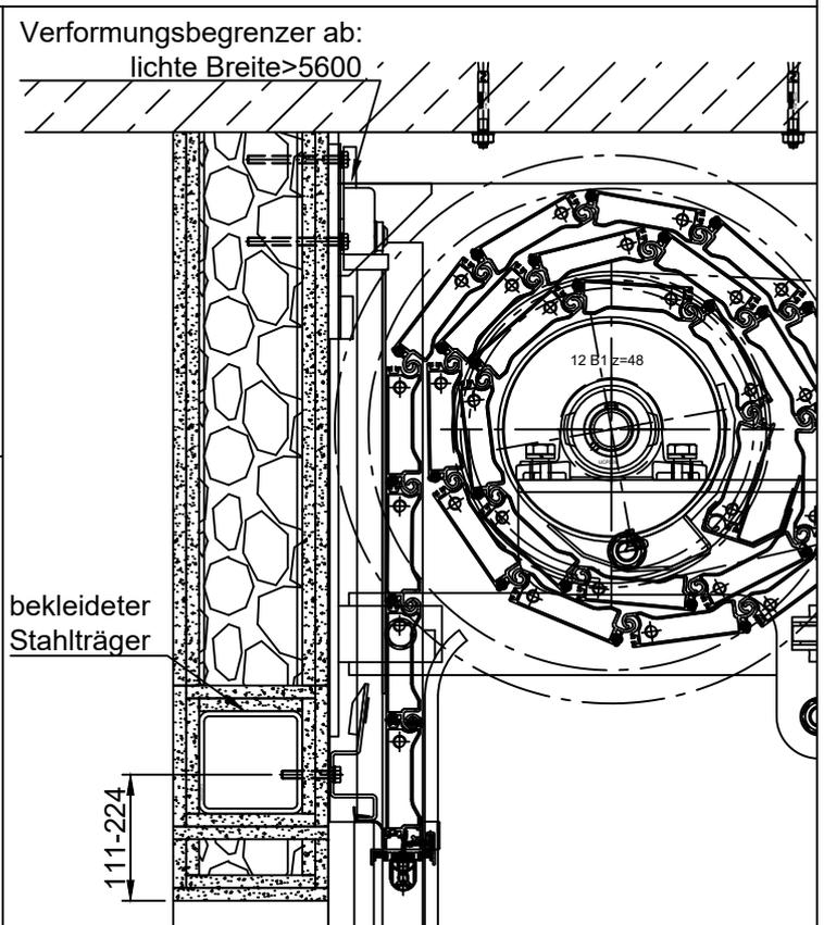
Die gesamte Unterkonstruktion (Rohre und Montagekonsolen) müssen vollständig mit einer El30-Bepankung geschützt werden. Zwischen der geschützten Unterkonstruktion und nebenliegenden Wänden kann eine Trockenbauwand gesetzt werden.
